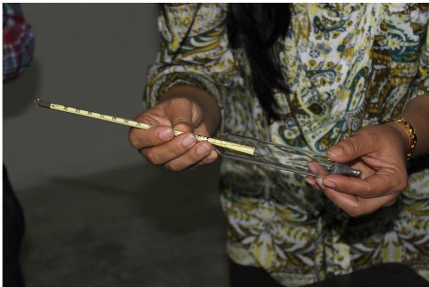
Figura 2. Hidrómetro para determinación de gravedad API
